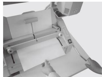
стола. Ручка переворота пресс-стола опускается вниз до упора и удерживается 5-7 секунд. Полностью клей застывает примерно через 1 минуту.
